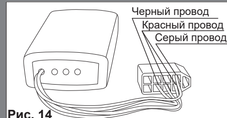
К-Line-адаптер (программатор) GF 911 производства «FERRUM»
