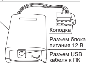
К-Line-адаптер (программатор) GF 911 производства «FERRUM»
