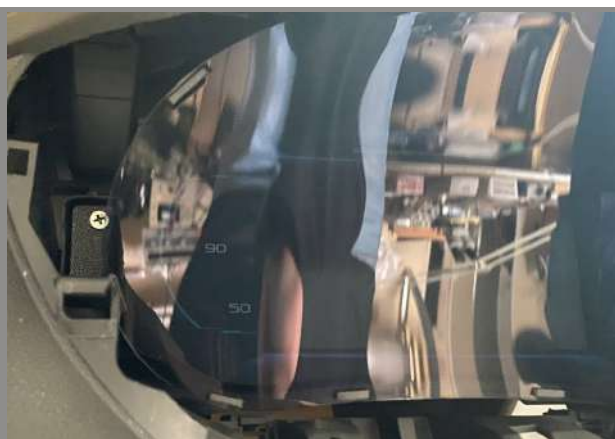
Рис. 6 Установить КП GF949 в посадочное место, закрепив её 2 штатными винтами.
