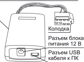
К-Line-адаптер (программатор) GF 911 производства «FERRUM»
