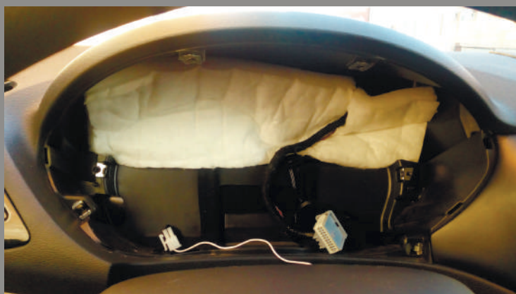
Рис. 5 Проложить внутри панели приборов провод для подключения программатора FERRUM
