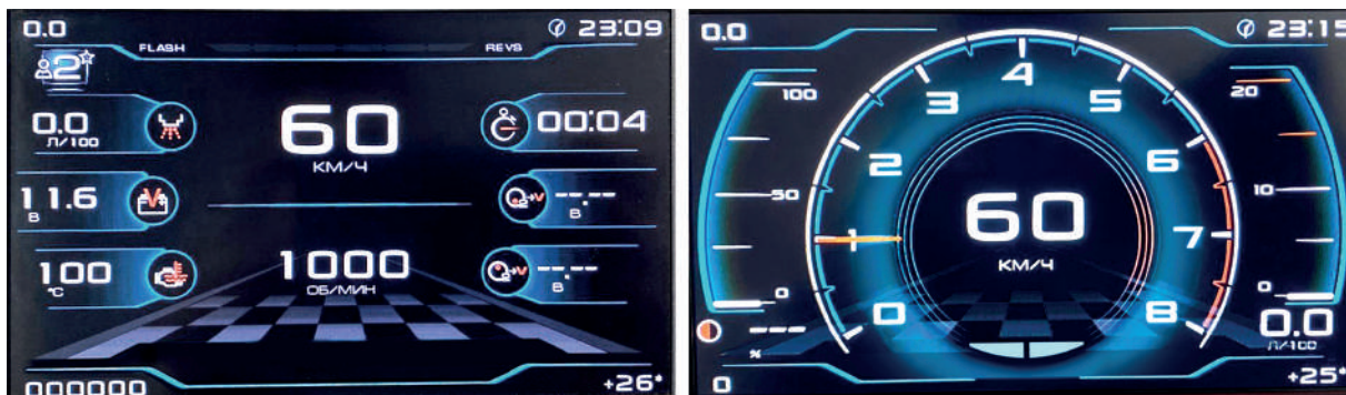
Рис. 17 Информационное поле ЭКП GF 949 N Слева - скин TURBO Справа - скин ARROW
